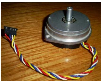
**Ilustración 9: Fotografía del motor paso a paso, junto con las conexiones eléctricas empleadas para conectarlo a la fase de potencia (ver texto).**
