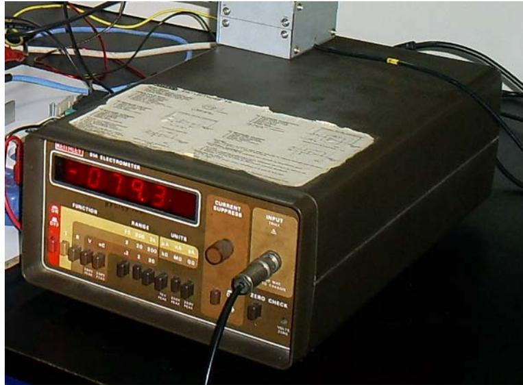
**Ilustración 18: Fotografía del espectrómetro KEITHLEY 614, este fue utilizado para recibir la señal de corriente del fotomultiplicador y convertirla en una señal análoga de voltaje.**
